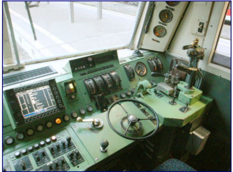
Ein Blick auf den Arbeitsplatz des Lokführers in der Baureihe 181 2 : Hier sind bereits einige Elemente des für die 111 entwickelten, integrierten Führerstands zu finden. Mit einem Handrad als Fahrstufenschalter blieb aber noch das klassische Aussehen erhalten.
