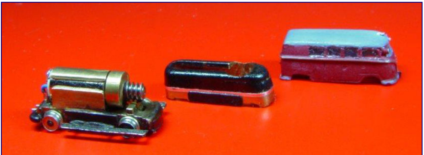
Das Fahrwerk, auf dem der Vibrationsmotor Platz nimmt, besteht aus Messing. Ein zusätzliches Messing-Formteil (Bildmitte) wird auf den Antrieb gestülpt und erhöht das Gewicht des kleinen Gefährts. Sobald das Gehäuse aufgesetzt ist, ist vom Innenleben nichts mehr zu sehen.
