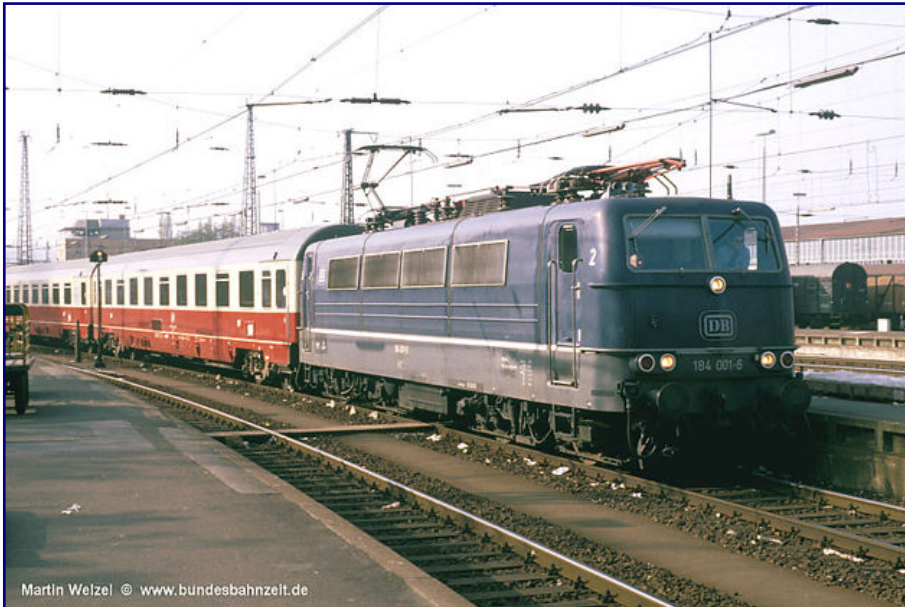
184 001-6 fährt mit TEE 33 „Parsifal“ am 31. Oktober 1978 in Aachen Hbf ein. Noch ist die Fahrleitung auf 3.000 V= geschaltet, deshalb hat die Lok den Stromabnehmer 1 für das SNCB-System angehoben. Foto: Martin Welzel ( http://www.bundesbahnzeit.de )
